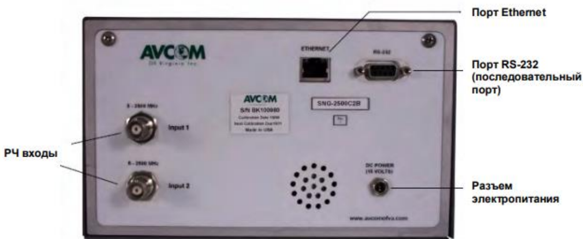
Рисунок 1.2.7.8.2– Описание элементов контроля на передней панели и разъемов на задней панели SNG 2500C2NE
